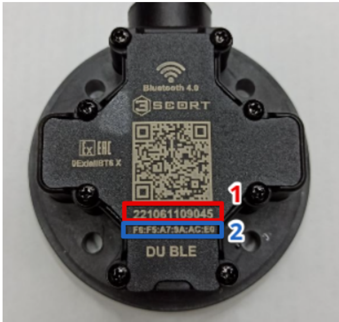
Рис. 17 MAC и серийный номер на старом дизайне (DU-BLE как пример)
