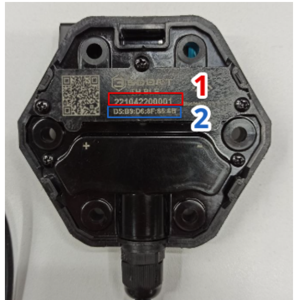
Рис. 18 MAC и серийный номер на новом дизайне (TH-BLE как пример)
