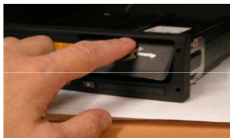
Рис. 2 Извлечение кассеты бумаги
