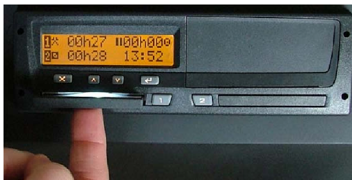
Рис. 7 Извлечение интеллектуальной карты из механизма помещения карты
